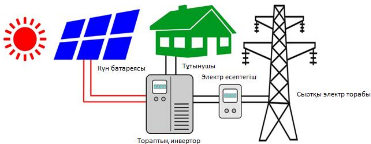
1 сурет - Желілік күн электр станциясы
